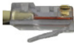
Insérer à fond dans le connecteur RJ45
